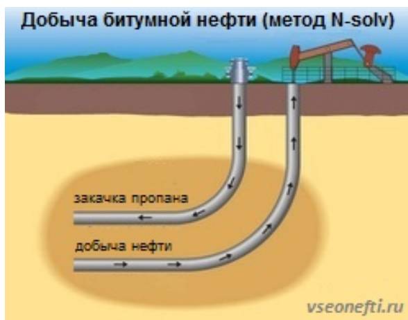
Рисунок Е.3.11 - Добыча битумной нефти (метод N-Solv)
