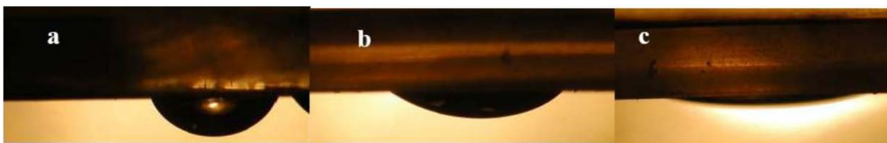
Рисунок Е.4.7 - Изменение контактного угла смачивания за 48 часов в случае различной концентрации MgCO_3 :
